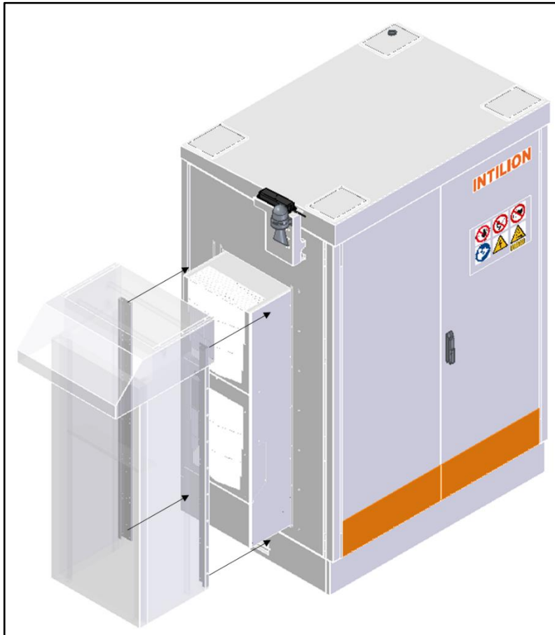
Abb. 57 Batteriespeicher – Schalldämmhaube aufsetzen
