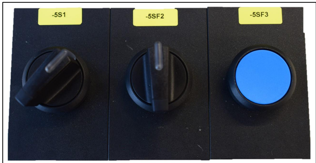
Abb. 12 Bedienelemente 5S1, 5SF2, 5SF3 im ControlShield rechts Mitte
